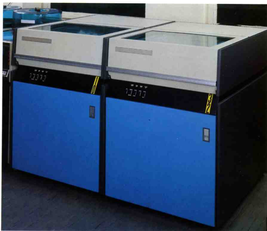
Zwei Plattenspeicher zu je 60 Mio Byte
