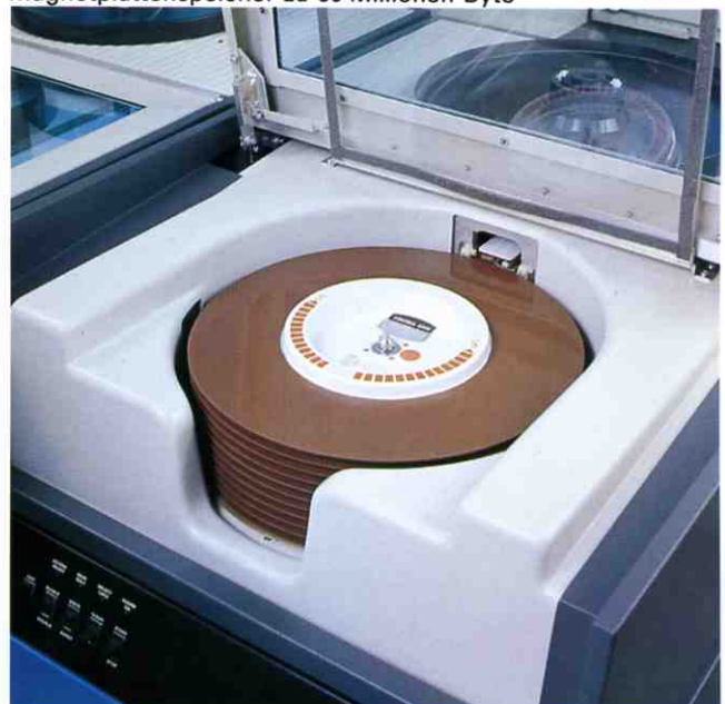
Magnetplattenspeicher zu 60 Millionen Byte
